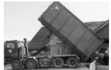
Abbildung 5 Brennstoffanlieferung mit LKW zu unterirdischem Silo
