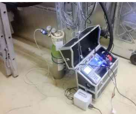
Aufbau der vereinfachten Abgasmessung.
