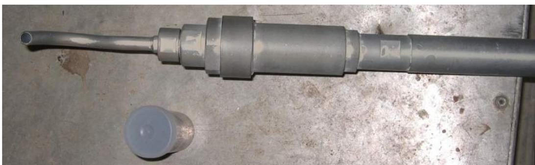
Bild 2 Isokinetische Absaugung, Fa. CheMin GmbH.
