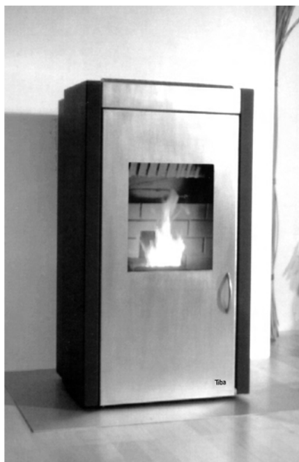
Abbildung 13 Pelletofen mit Warmluftabgabe und integriertem Pelletbehälter, 2,5 bis 10 kW. Verbrennung in einer Retorte mit Beschickung durch Fallrohr (Tiba).
