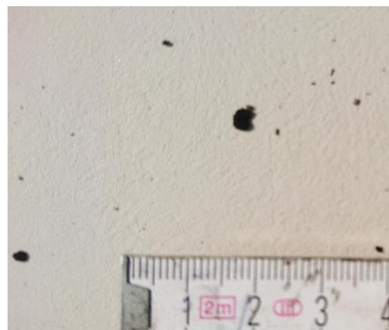
Bild 10 Beispielbilder von Grobstaubemissionen des Zentralheizungsherds der Anlage 1007 kurz nach dem Anfeuern bei ausgeschaltetem Elektroabscheider. Links: Bild des Grobstaubsensors. Rechts: Ablagerungen im Freien auf den Messgeräten neben dem Kamin während der Messung.
