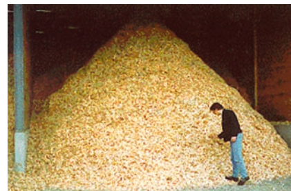
Bild 6/figure 6 Holzschnitzellager ebenerdig unter Dach Magasin de plaquettes de bois de plain pied sous un toit
