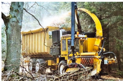
Bild 4/figure 4 Herstellung von Holzschnitzeln mit mobilem Grosshacker im Wald Production de plaquettes de bois directement en forêt au moyen d'un hachoir
