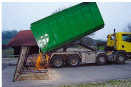
Bild 5 /figure 5 Brennstoffanlieferung mit LKW zu unterirdischem Silo älterer Bauart. Für Neuanlagen wird eine Öffnungsmöglichkeit der Silodeckel von über 90 ° empfohlen, um eine rasche und störungsfreie Brennstoffanlieferung zu ermöglichen. Fourniture de combustible par camion dans un silo de type ancien. Pour de nouvelles installations, il est recommandé de prévoir une possibilité d'ouverture du couvercle à 90° afin de permettre une livraison sûre et rapide du combustible.
