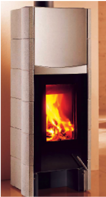
Bild 1 / figure 1 Zimmerofen (Speicherofen) mit oberem Abbrand, heisser Ausbrandzone oberhalb des Brennraums und nachgeschalteter Wärmeübertragung auf Speichersteine (Tonwerk Lausen).
