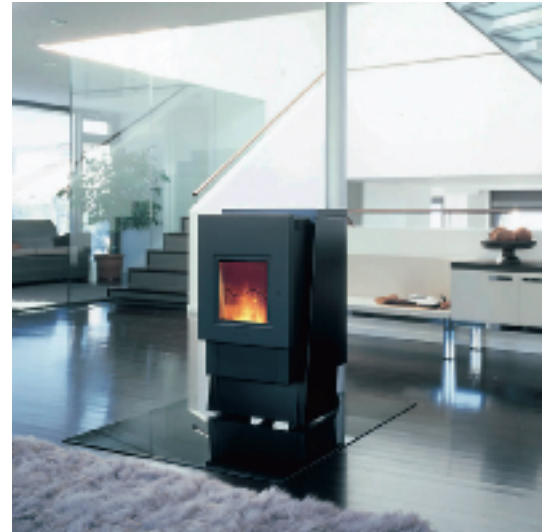
Bild 12 / figure 12 Pelletofen mit Warmluftabgabe und integriertem Pelletbehälter, 2,5 bis 10 kW. Verbrennung in einer Retorte mit Beschickung durch Fallrohr (Wodtke).
