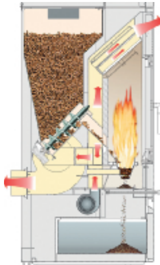
Bild 12 / figure 12 Pelletofen mit Warmluftabgabe und integriertem Pelletbehälter, 2,5 bis 10 kW. Verbrennung in einer Retorte mit Beschickung durch Fallrohr (Wodtke).
