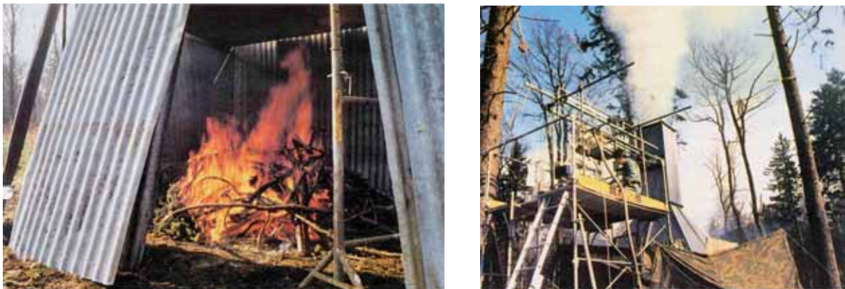
Bild 3.10 Versuchsanordnung zur Emissionsmessung an einem offenen Waldfeuer bei der Verbrennung von Schlagabraum mit einer Feuerungsleistung von rund 500 kW [Stettler und Grünenfelder 1996].
