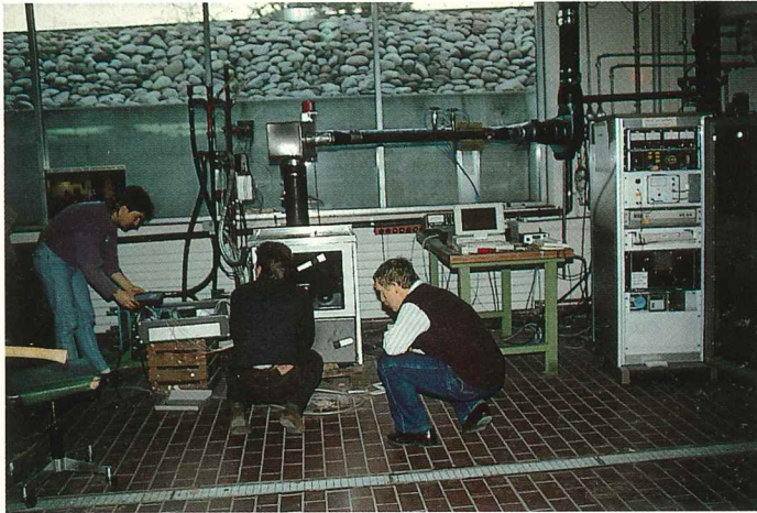
Prüfstand mit Abgasvolumenstrommessung
