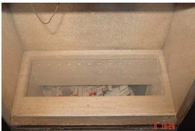
Bild 12: Ofentyp 3 am Ende der Ausbrandphase. Die noch glimmenden Holzstücke sind unten in der Retorte erkennbar. Flammen aus den Sekundärluftdüsen entstehen keine mehr.
