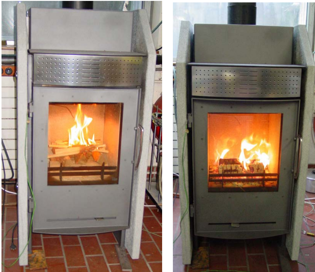
Bild 7: Ofentyp 2 im Idealbetrieb. Der Ofen wurde mit einer kleinen Menge trockenem Holz beladen und von oben angezündet (links). Nach Erreichen einer Grundglut wurden 2 kleine Holzstücke à 750 g nachgelegt (rechts).
