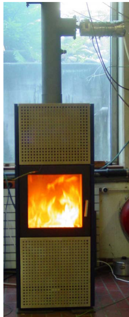
Bild 8: Prinzipskizze des Ofens (links) und Betrieb im Labor (rechts). Die beheizte Staubmessung ist oben rechts am Abgasrohr montiert.
