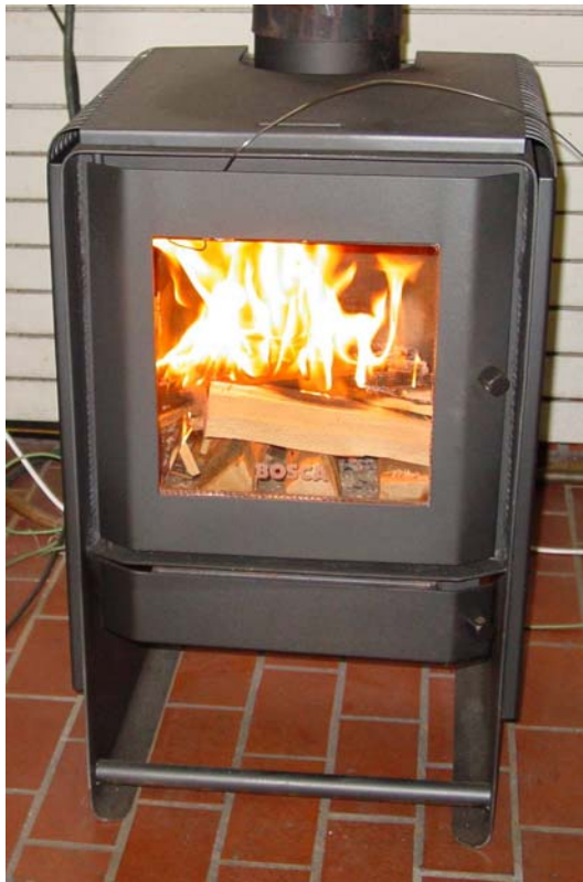
Bild 4: Ofen 1 im Ideal-Betrieb mit trockenem Holz, von oben angezündet (links), und Nachlegen auf Grundglut (rechts).
