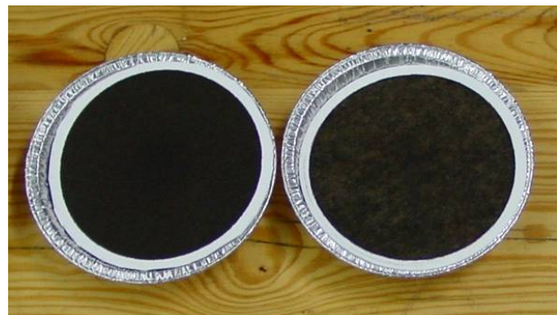
Bild 29 Proben von Holzofentyp 1 bei schlechtem Betrieb: Inhalt der Kondensatwaschflaschen (links) und Filter (rechts)
