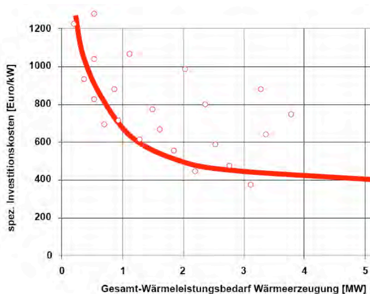
Bild 5.3 Spezifische Investitionskosten für Technik und Gebäude von Holzheizwerken ohne Fernwärmenetz bei Neubau auf erschlossenem Bauland in der Ebene in Funktion der Leistung. Berücksichtigt sind die gesamten Investitionskosten für Technik und Gebäude (Heizkessel, Heizraum, Kamin, hydraulische Einbindung, Steuerung und Brennstofflagerung mit Austragung). Die Linie zeigt die bei korrekter Planung und Ausführung erreichbaren Werte [Good et al. 2004], die Punkte illustrieren exemplarisch die typische Streubreite von während der letzten zehn Jahre realisierten Anlagen.
