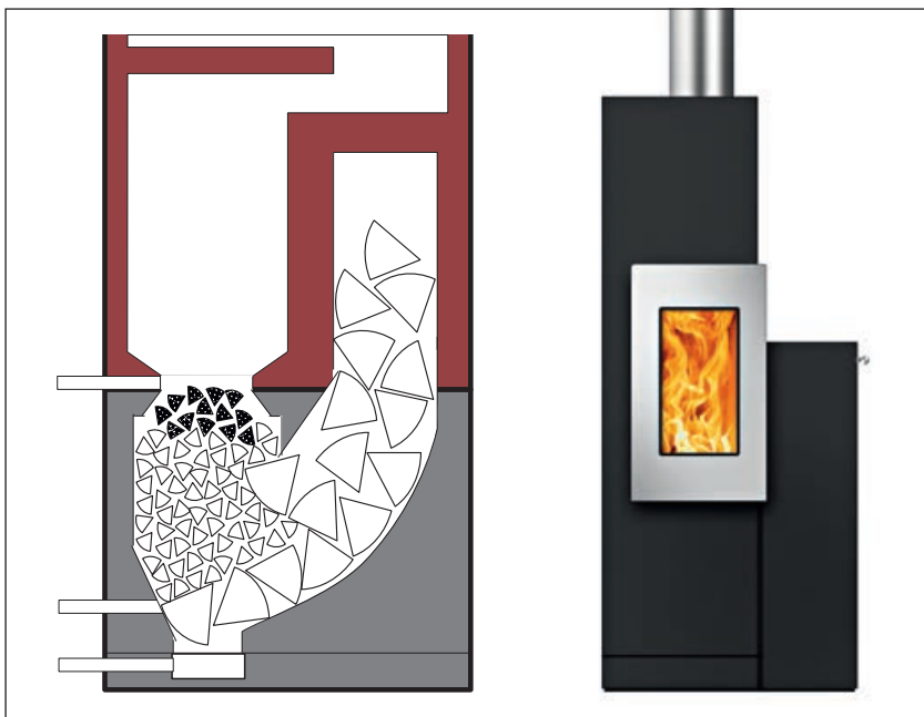
Abb 2 Holzofen mit Verbrennungsretorte und zweistufiger Verbrennung (Odermatt & Nussbaumer 2012). Schema (links) und Beispiel einer Ausführung (rechts). Foto: Tiba AG
