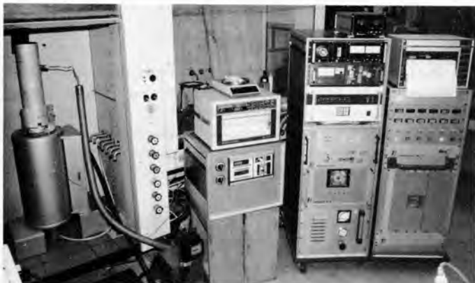
Bild 7 Versuchsanordnung mit Laborofen (links), Steuerung (Mitte) und Rauchgasanalyse (rechts).
