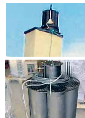
Bilder 4a und 4b: Prototyp eines elektrostatischen Feinstaubabscheiders zum Aufbau auf den Kamin.
